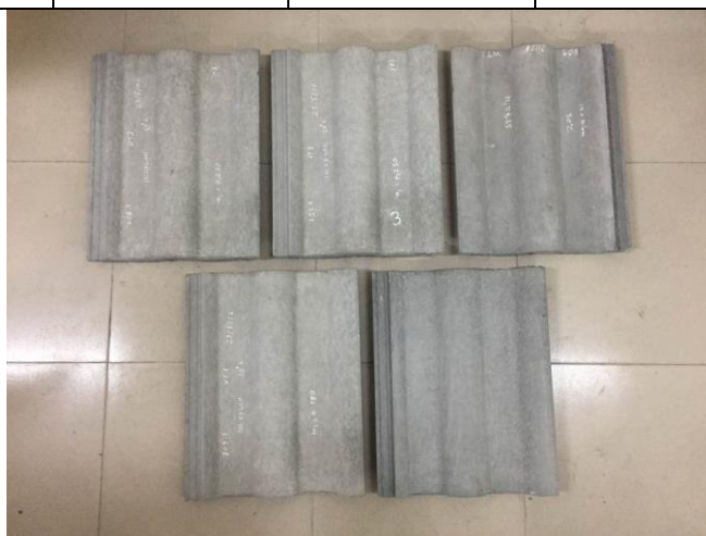
Hình 6. Thí nghiệm kiểm tra cường độ uốn gãy toàn viên
