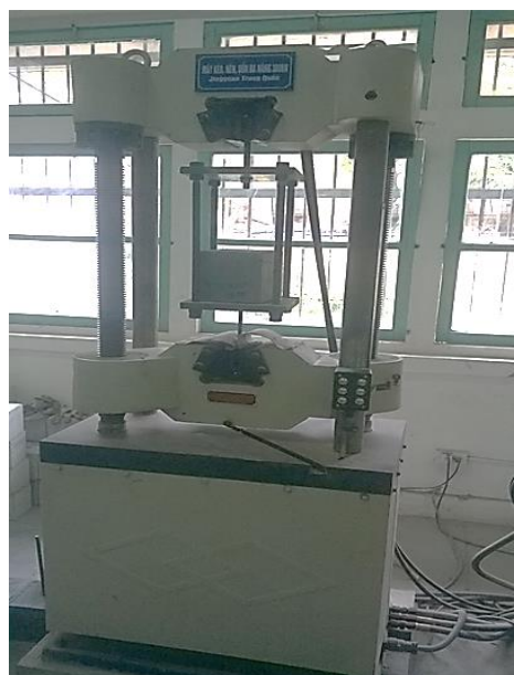
b, Lắp khung thép thí nghiệm lực nhỏ của cốt thép trong bê tông
