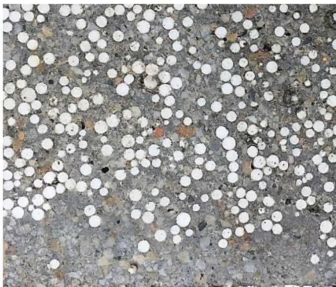
Hình 3.5 Phân tầng trong bê tông polystyrene kết cấu
