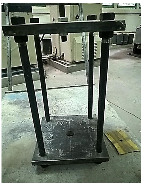
a, Khung thép lắp mẫu thí nghiệm xác định lực nhỏ của cốt thép trong bê tông
