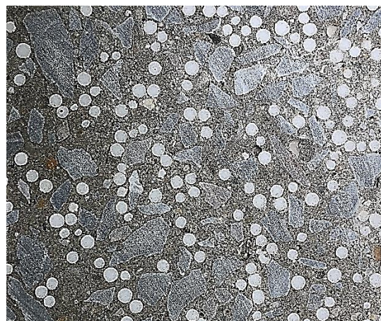
Hình 3.10 Bê tông BPK sử dụng bê tông nền M200.80.21V15
