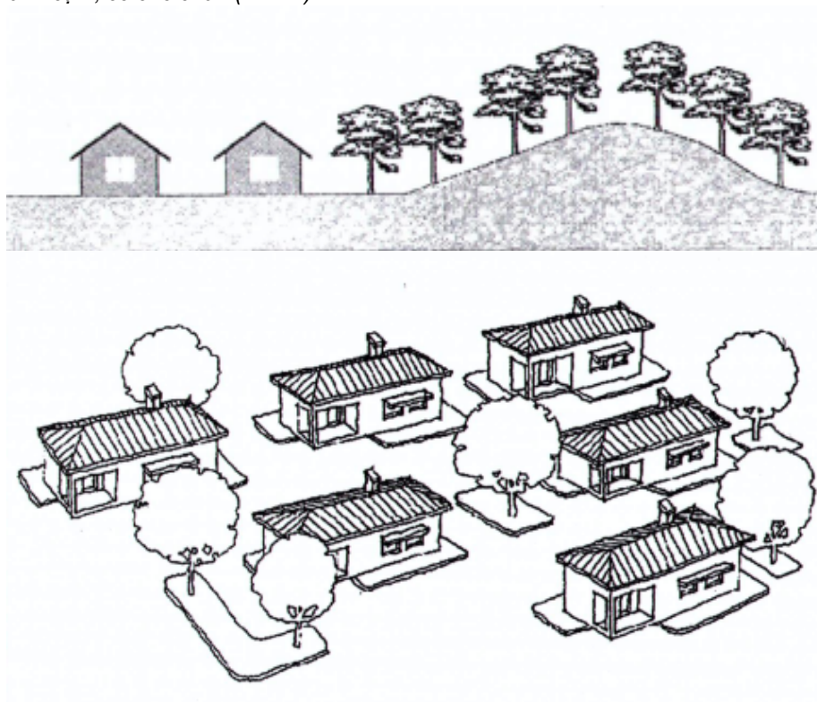
Hình 2. Nhà xây thành cụm, có che chắn
