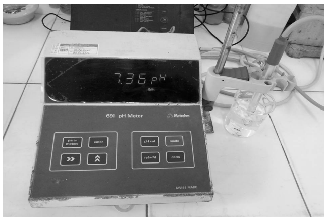
Hình 6. Đo độ pH của mẫu bột bê tông tại phòng thí nghiệm
