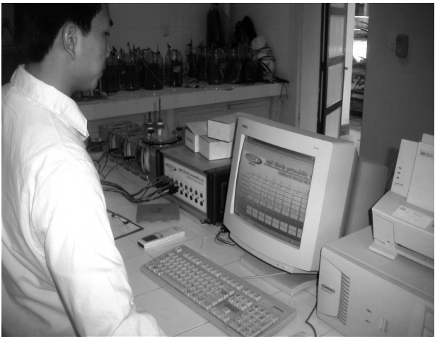
Hình 4. Đo mức độ thấm ion clo bằng phương pháp đo điện lượng
