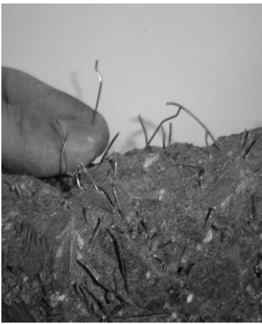
4b. Sợi giãn nhiều, tuột khỏi liên kết với đá xi măng và 1 số sợi đứt khi uốn
