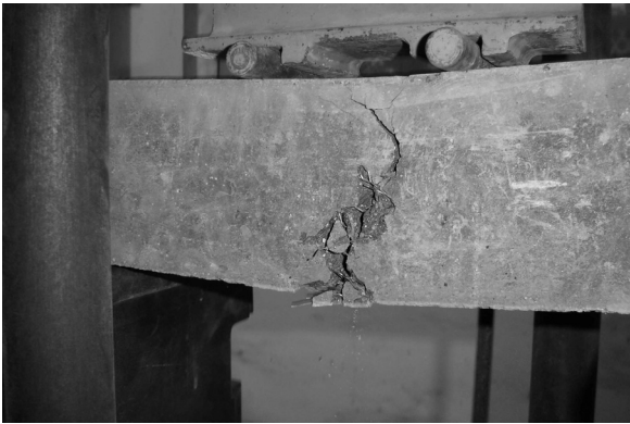
Hình 2. Thí nghiệm uốn mẫu BTCS thép
