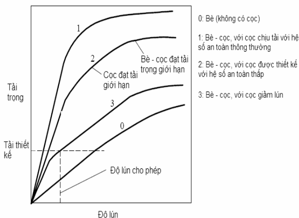
Hình 1 Sự làm việc của hệ bè - cọc
