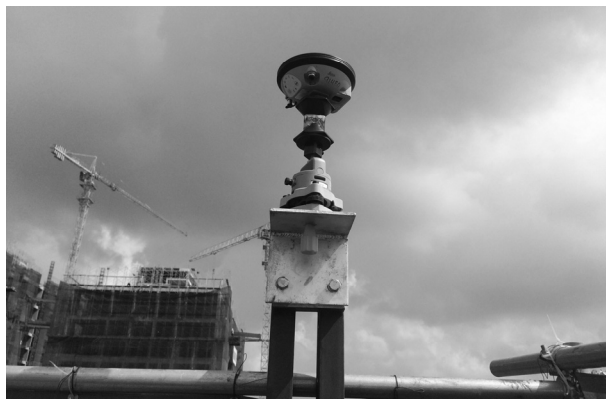
Hình 3. Máy thu GPS lắp tổ hợp với gương Leica 360°
