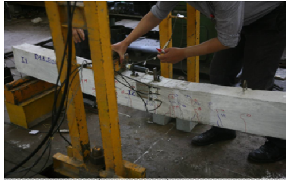
Hình 8. Dầm sau khi kết thúc thí nghiệm
