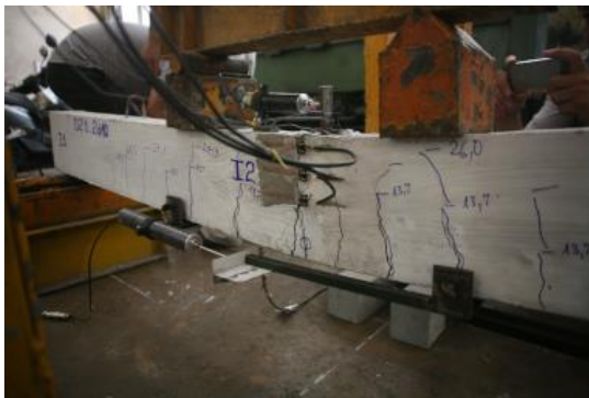
Hình 9. Sự phát triển vết nứt dầm D2.1
