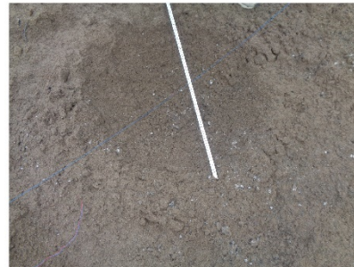
b. Phểu nổ hình thành khi nổ trong môi trường đất
