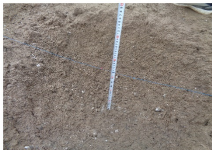
b. Phểu nổ hình thành khi nổ trong môi trường đất
