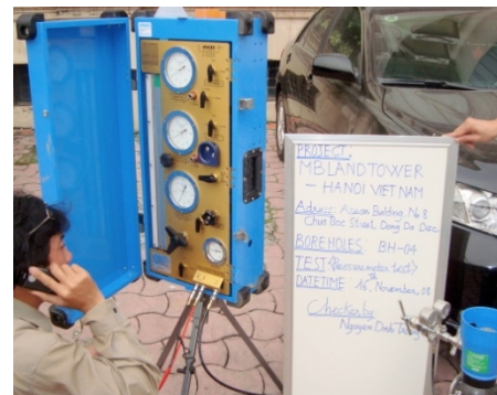
Đo địa chấn hồ khoan và nén ngang trong hồ khoan CT MB Land Tower số 8 Chùa Bộc – Hà Nội
