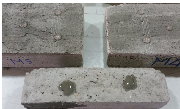
Hình 6. Khả năng chống thấm bằng trực quan
