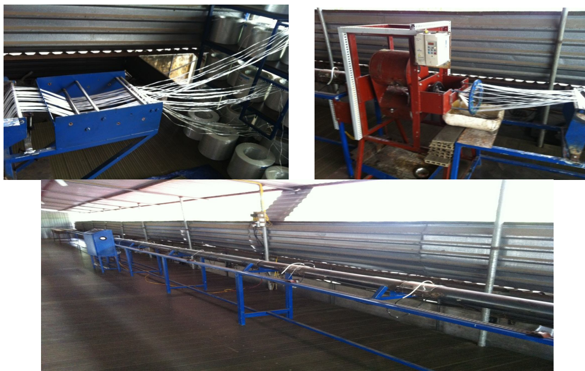
Hình 1. Hệ thống dây chuyền sản xuất thanh cốt composite polymer
