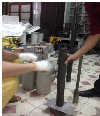
Hình 9. Thí nghiệm độ bền va đập
