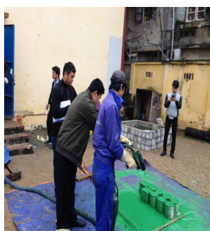
b) Phun sơn polyurea tạo mẫu thử
