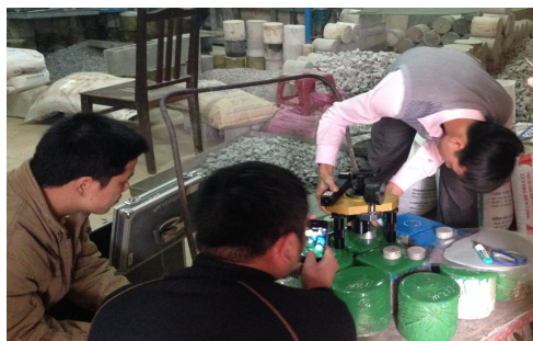
Hình 5. Thí nghiệm độ bám dính của hệ sơn polyurea với nền bê tông
