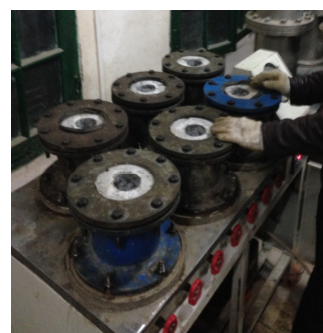
c) Lắp đặt mẫu và tiến hành thử thấm
