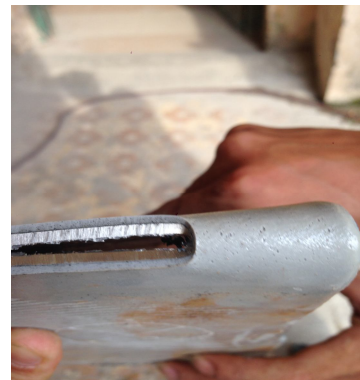
Hình 10. Thí nghiệm độ bền uốn 90 0
