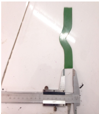
Hình 8. Chuẩn bị mẫu thử kháng xé rách
