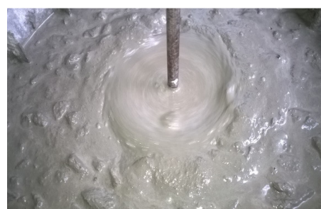
(c) Bình chứa đầy bê tông và xi lanh quay
