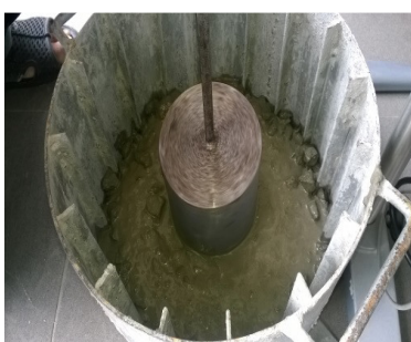
(b) Xi lanh quay và thùng chứa, bê tông đổ trong bình với cao độ đủ tiếp xúc với mặt dưới xi lanh
