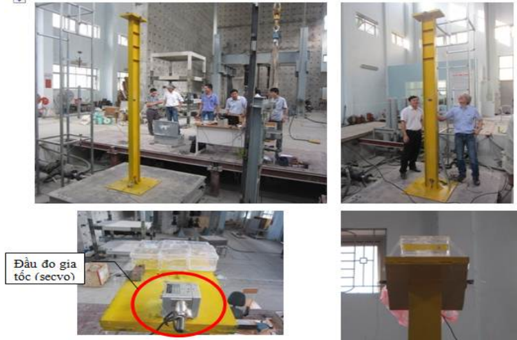
Hình 6. Sơ đồ hệ thống điều khiển bàn rung và mô hình thí nghiệm trên bàn rung và các giảm chấn
