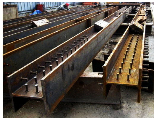
Hình 1. Đỉnh chống cắt bố trí trên kingpost ở vị trí liên kết với bê tông cọc khoan nhồi a) Cấu tạo đỉnh; b) Ảnh thực tế thi công
