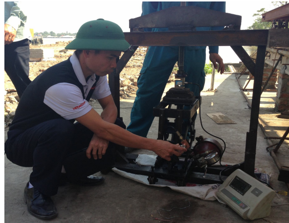
Hình 14. Thí nghiệm hiện trường để khảo sát đặc tính cơ học của mô hình cụm bánh xe.
