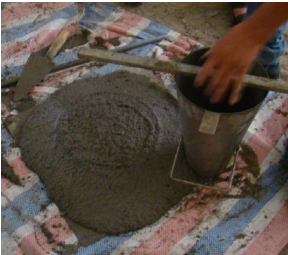
Hình 5-24: Kiểm tra độ sụt của bê tông trước khi đổ mẫu
