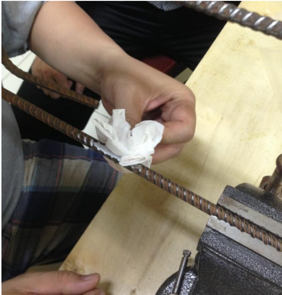
Hình 5-21: Mài phẳng, làm sạch trước khi dán phiến lên cốt thép
