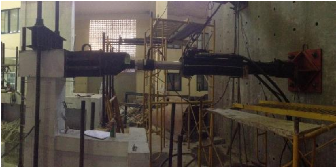
Hình 5-31: Lắp kích thủy lực
