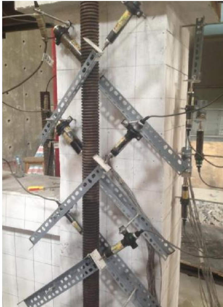
Hình 5-32: Lắp thiết bị đo
