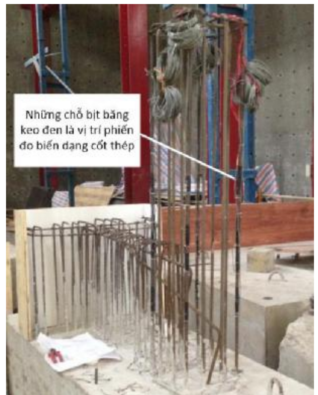
Hình 5-9: Hình ảnh thanh thép dán phiến trong quá trình thi công mẫu
