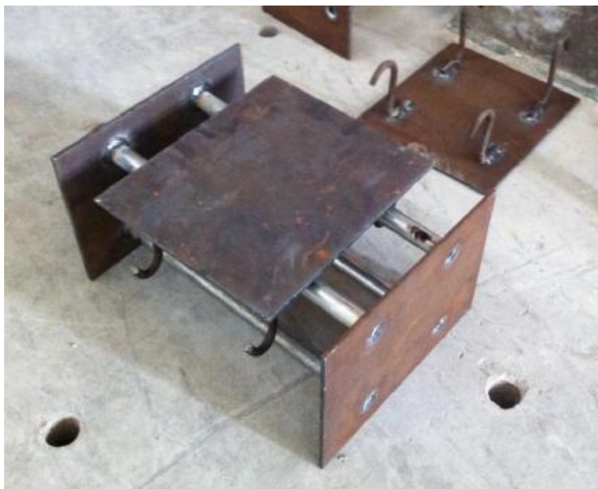
Hình 5-27: Chế tạo chi tiết thép đặt sẵn để bắt đầu kích
