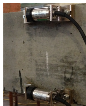
c- Đo biến dạng bê tông (ST-1 và ST-2)
