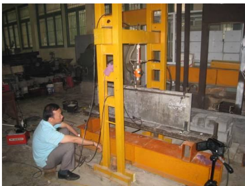
Hình 3. Mẫu dầm thí nghiệm trước và sau khi phá huỷ
