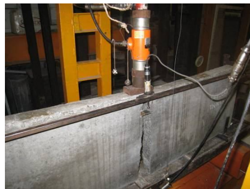
Hình 3. Mẫu dầm thí nghiệm trước và sau khi phá huỷ
