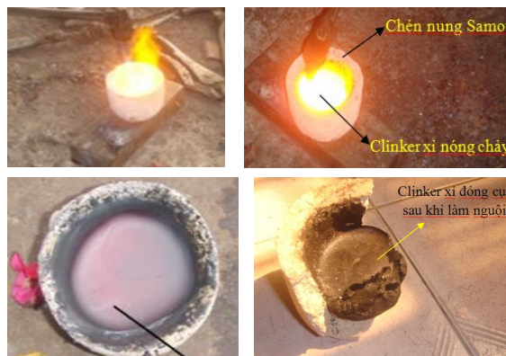
Hình 6. Phối liệu nung chảy dưới mô hàn oxy-acetylen và sau khi làm nguội
