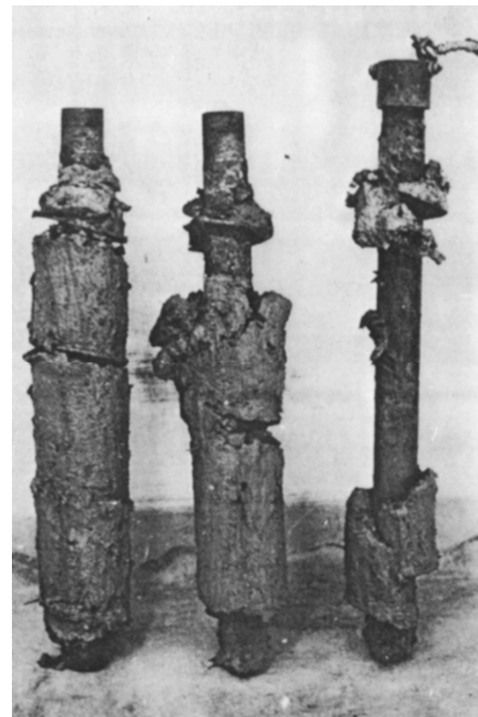
Hình 2. Ảnh hưởng của khoảng cách giữa các cánh tới sự làm việc của cọc vít thông thường (Narasimha Rao và cộng sự, 1989)
